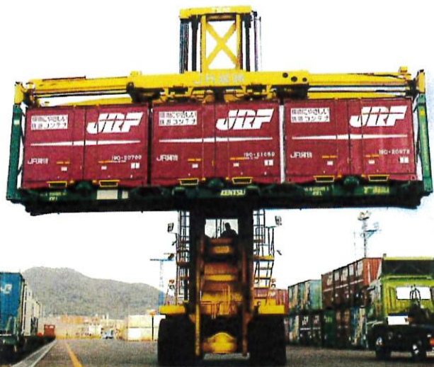
12フィートの鉄道コンテナが3個収まる 40フィートサイズの「ラックコンテナ」
